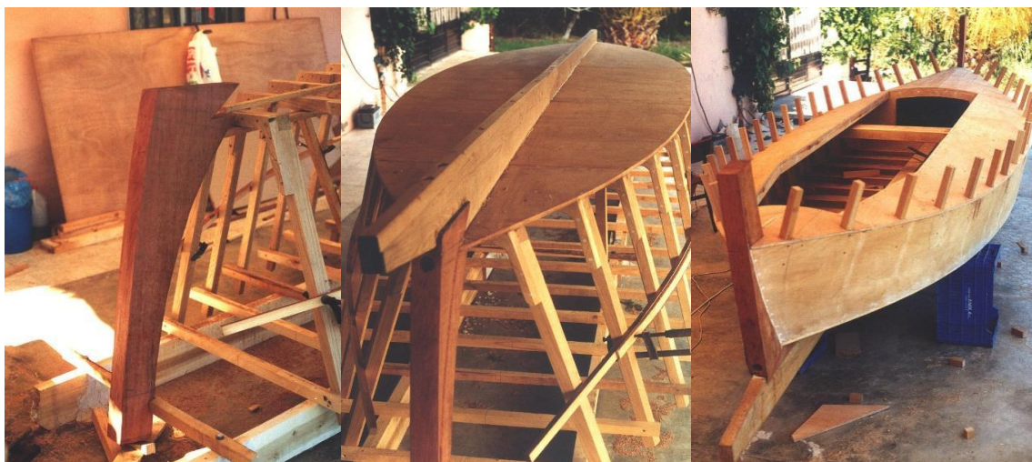
Imagen 2. Imágenes del proceso de fabricación de una barca tradicional de la Albufera de Valencia.
