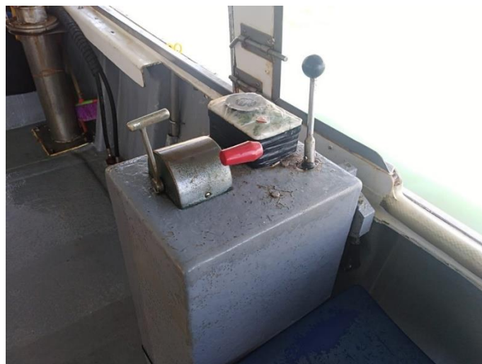
Imagen 22. Control de mando independiente del timón del barco de estudio.
